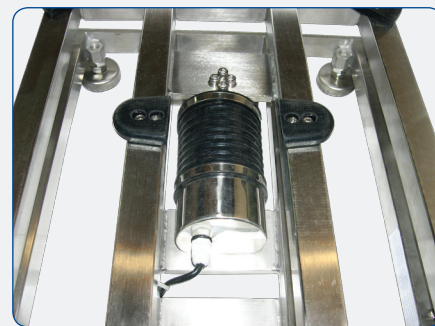
Detalle de la célula de la versión 2 Détail du capteur de la version 2 Load cell version 2 detail
